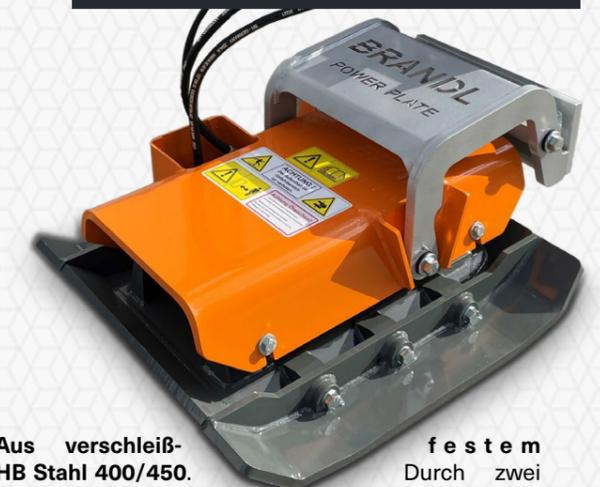
Aus verschleißfestem **HB Stahl 400/450**. Durch zwei schraubbare Verbreiterungen entstehen drei Optionen in der Breite des Unterteils 850 oder 700 oder 550 mm. Frei liegende Schraubkanten werden über schraubbare Flankenschutzbleche geschützt.
